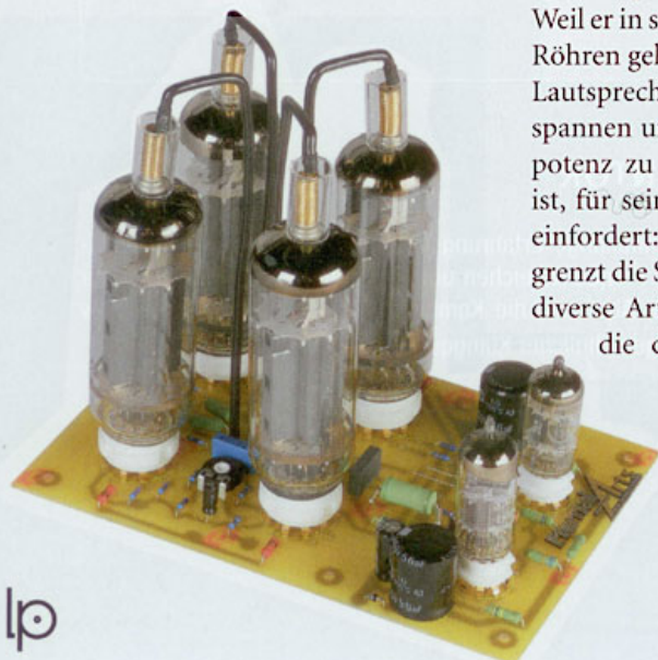
Zentralorgan: Diese Platine übernimmt die komplette Verstärkungsarbeit für einen Kanal
